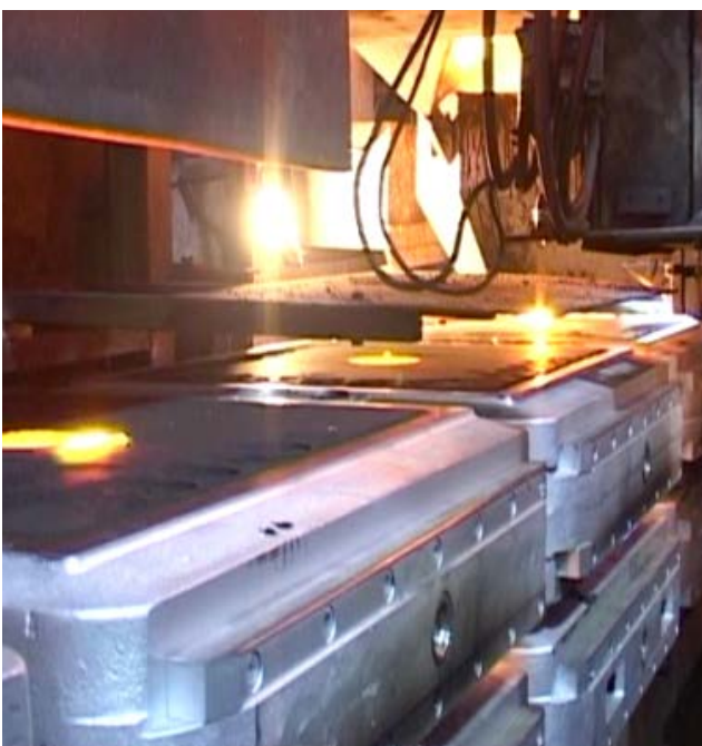
Installation de moulage : coulée dans les moules en sable
