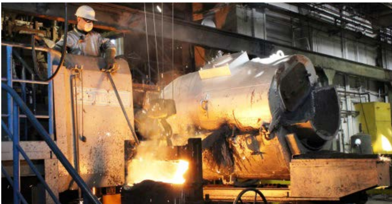
Département de fusion : prélèvement de métal en fusion du avant-creuset
