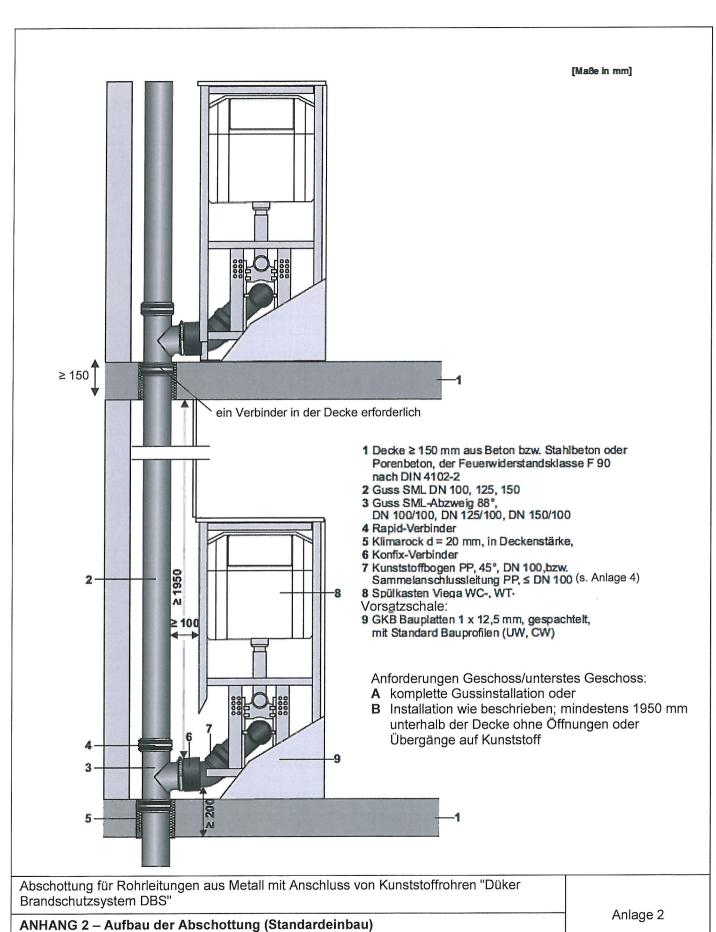
Anschluss eines oder mehrerer Sanitärinstallationsobjekte über 45° Kunststoff-Rohrbogen
