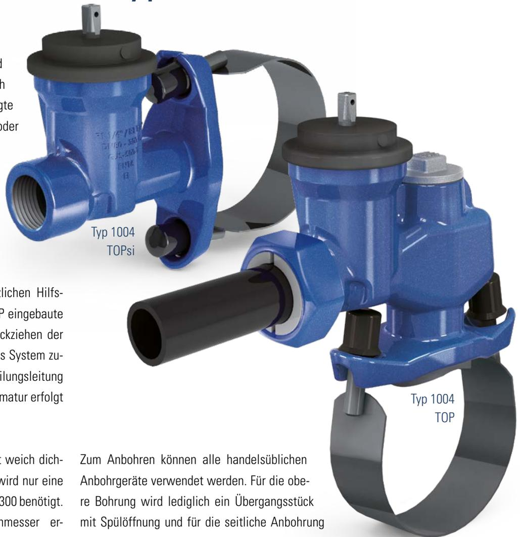
Zum Anbohren können alle handelsüblichen Anbohrgeräte verwendet werden. Für die obere Bohrung wird lediglich ein Übergangsstück mit Spülöffnung und für die seitliche Anbohrung ein Doppelnippel benötigt.
