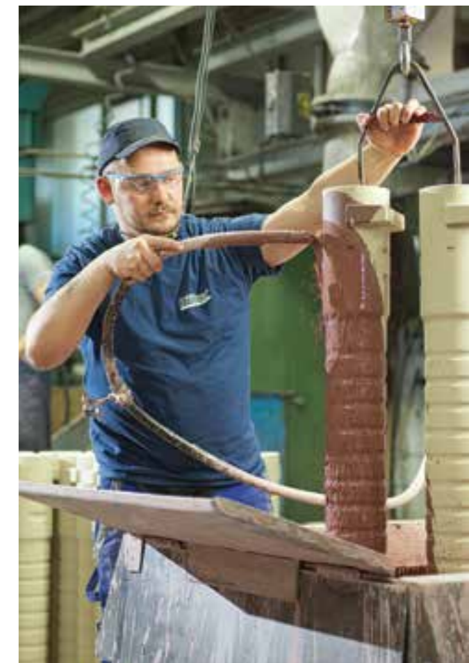
Auftrag der Wasserschichte auf Kerne
