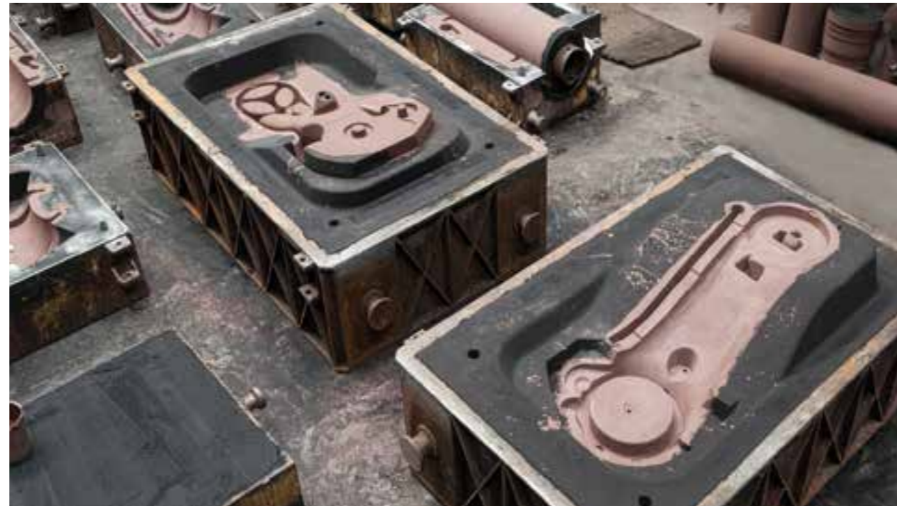
Formober- und Formunterkasten für individuellen Sandformguss
