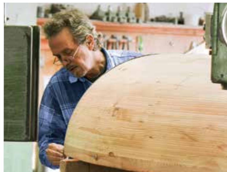
Fertigung eines Modelles aus Holz nach CAD-Daten
