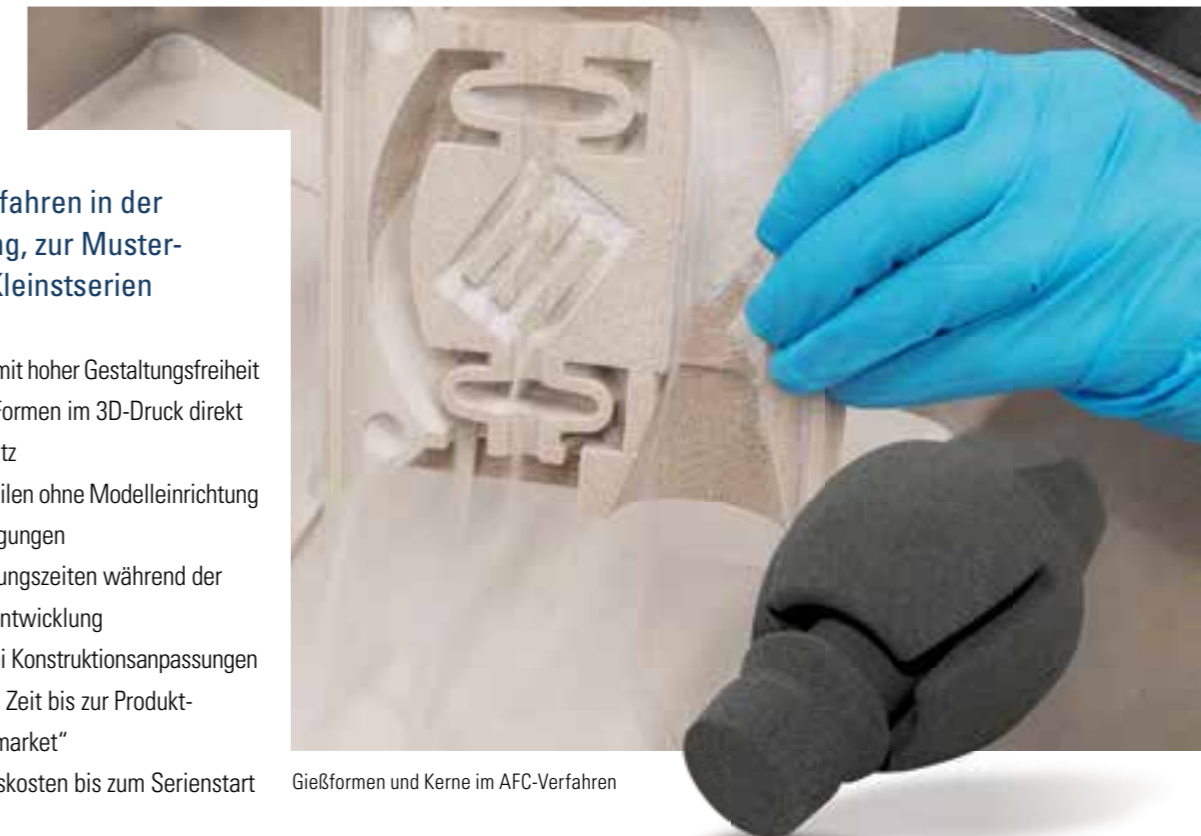
Formober- und Formunterkasten für individuellen Sandformguss
