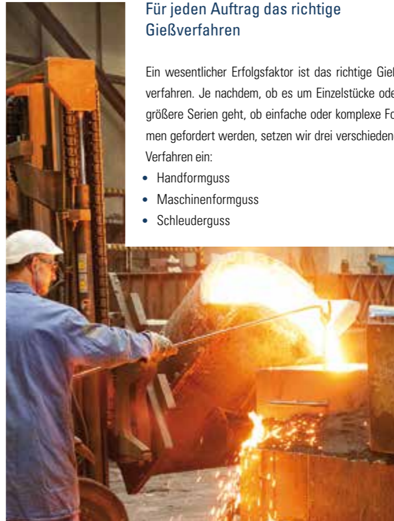
Abguss eines Einzelstückes im Handformguss
