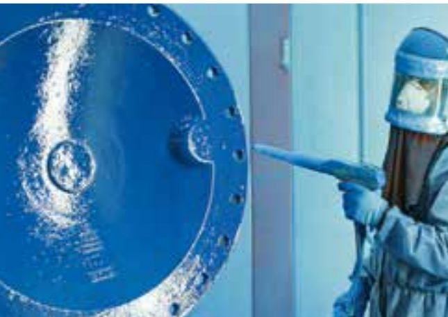
Oberes Bild: Pulverbeschichtung von Großteilen
