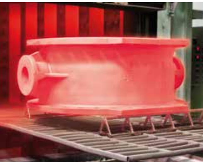
Unteres Bild: Emailiertes Klappengehäuse nach dem Brennen
