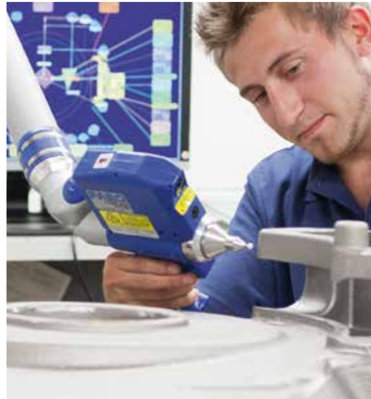
Oberes Bild: 3D-Scan mit FARO-Messarm
