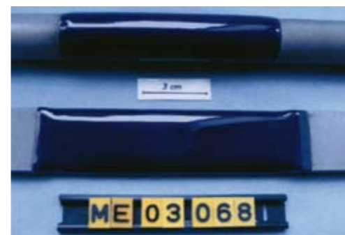
Außen emaillierte Rohrprobe DN 15 für den Zugversuch (oben), einseitig emaillierte Flachprobe für den Dreipunkt-Biegeversuch (unten)
