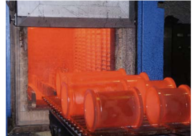
Abb. 4: Bauteile nach Abschluss des Brennvorganges vor dem Ofen. Eine homogene Temperaturverteilung innerhalb des Bauteiles ist Voraussetzung für die Qualität der Emaillierung.
