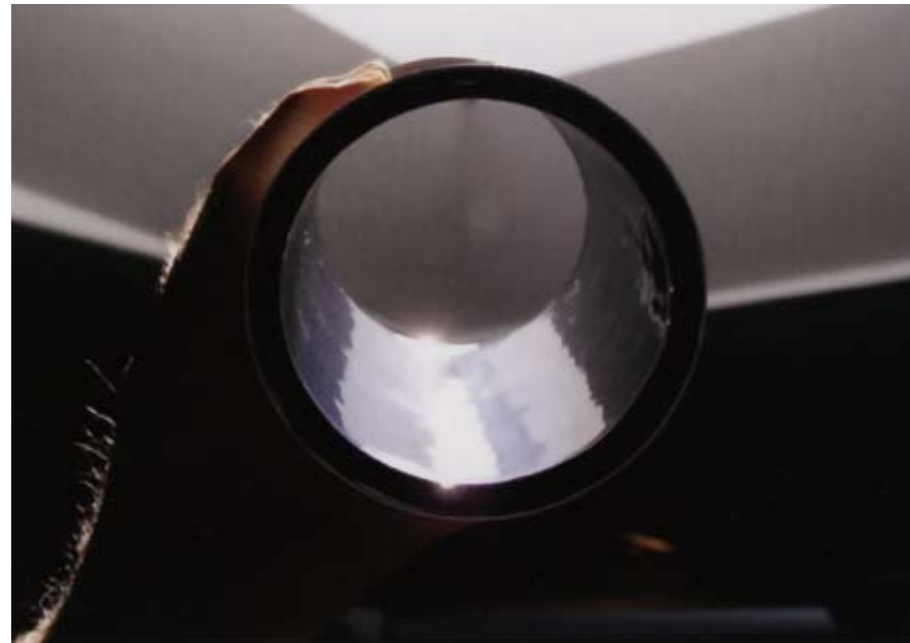
Abb. 1: Technisches Email – extrem glatte Oberflächenbeschaffenheit in Verbindung mit hohem Verschleißwiderstand gegen abrasiv wirkende Medien und hoher Korrosionsresistenz. Visuelle Prüfung der Oberfläche im Gegenlicht.
