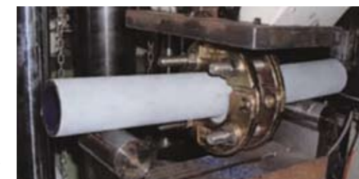
Versuchsanordnung Dreipunkt-Biegeversuch an zwei zusammengeflanschten Rohrenden DN 50
